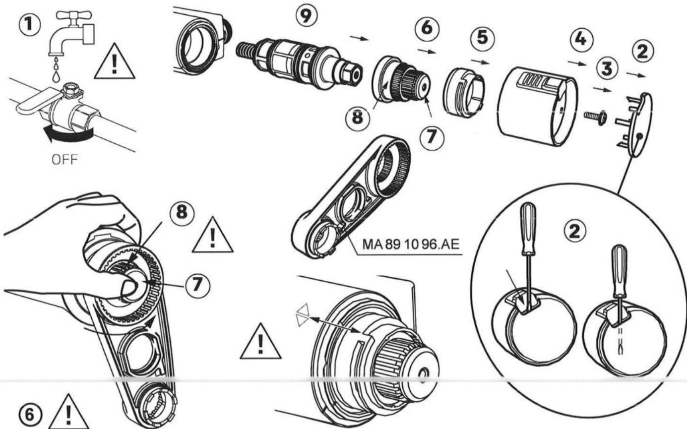
**SV** Tryck in spindeln [7] och håll fast den så att den inte roterar med, samtidigt som muttern [8] skruvas med serviceverktyg (891096.AE). Dra ut termostatinsatsen [9] och montera den nya i omvänt ordning. Kalibrera temperaturen [10].
