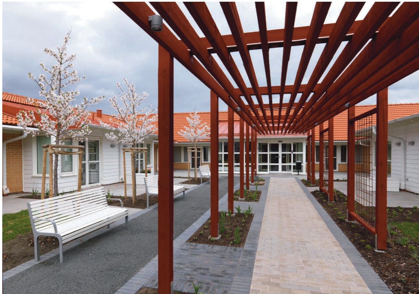
Vistegården består av fyra bostadsgrupper med tolv lägenheter i varje. Gårdarna mellan husen är sammankopplade, för att alla skall kunna ta del av de olika trädgårdarna. Det är lätt att ta sig fram på de plana gångytorna som är anpassade för att rymma rörelsehindrade och möten med t ex rullatorer.
